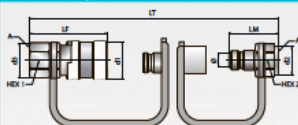
Примечание. Уплотнительная шайба и соединитель, включенные в HMV NIPPLE 1/4, не представлены на рисунке.
