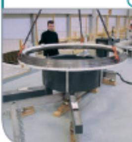
Такой нагреватель, специально разработанный для использования в сфере производства агрегаторов, способен нагревать до 120°C за 60 минут детали весом до 10 тонн с наружным диаметром до 4 метров.
