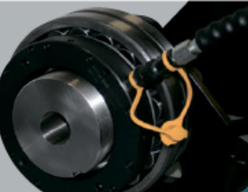
Снятие стяжной втулки с помощью гидравлической гайки
