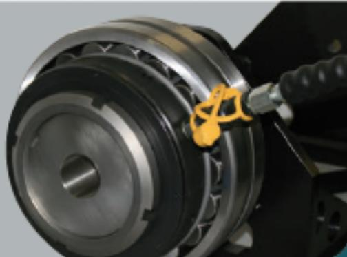
Снятие закрепительной втулки с помощью гидравлической гайки
