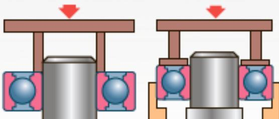
► В случае длинного вала в процессе монтажа требуется регулировка положения подшипника на валу. При этом рекомендуется использовать втулку с конической опорной поверхностью совместно с подшипником с коническим отверстием.
