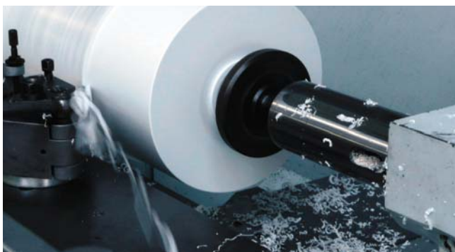
Стружка при точении
