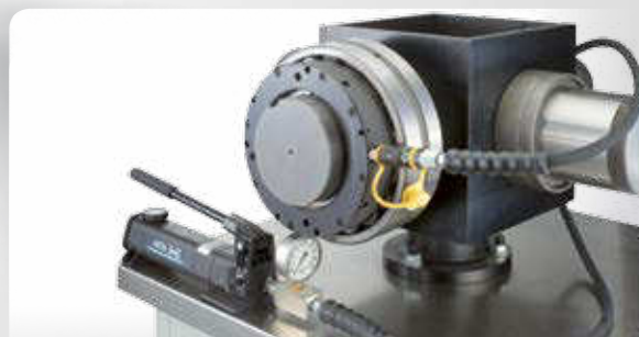
Извлечение стяжной втулки с помощью гидравлической гайки
