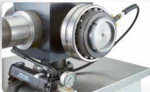
Извлечение закрепительной втулки с помощью гидравлической гайки
