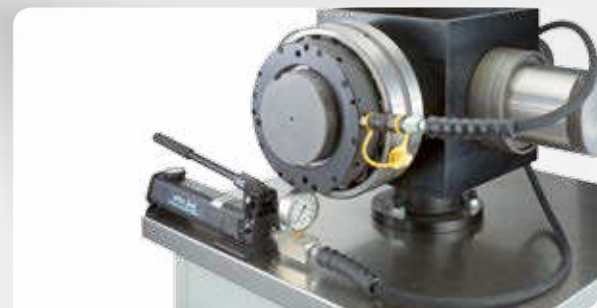
Установка на втулку с гидравлической гайкой
