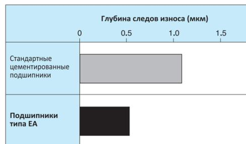
**Рис. 8 Результаты испытаний на износ**
