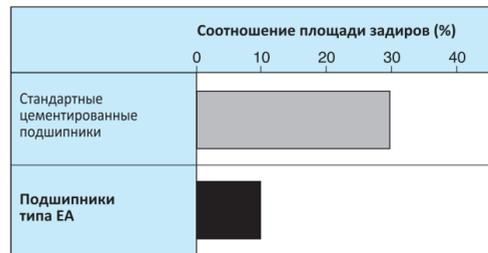
**Рис. 7 Результаты испытаний поверхностной прочности**
