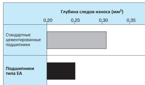
**Рис. 8 Результаты испытаний на износ**
