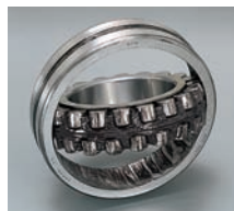
После испытаний открытого подшипника
