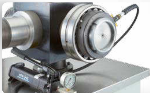
Извлечение закрепительной втулки с помощью гидравлической гайки
