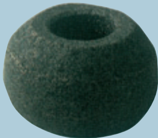
NTN BEARPHITE graphite skeleton 上記軸受の溶解後のグラファイトスケルトン
